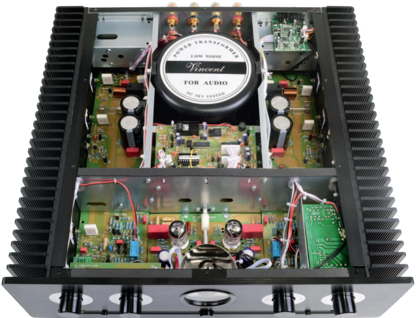
Die üppig ausgelegte Elektronik des Vincent füllt den normbreiten Amp praktisch aus. Rechts hinten der eingebaute DAC mit optischem und koaxialem Eingang, in der Mitte links und rechts die beiden Endstufen-Sektionen mit den an die Kühlrippen isoliert, aber wärmeleitend angeflanschten, bipolaren Endtransistoren. Die Eingangsröhre ECC83 (vorne in der Mitte) sitzt in einem rot beleuchteten „Zimmerchen“.
