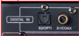
Mit der Modellpflege zum SV-237MK musste der USB-Anschluss weichen. Nun kümmern sich ein optischer und ein koaxialer Anschluss um digitale Signale, die im Falle der Koax-Buchse bis hin zu 24 Bit/192 kHz reichen dürfen. Wer den Vincent als Röhren-Vorverstärker nutzen möchte, kann dies via „Pre Out“-Buchse tun, daneben der gute, alte „Record“-Ausgang.
