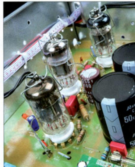
Drei Doppeltrioden obliegt die Spannungsverstärkung für beide Kanäle
