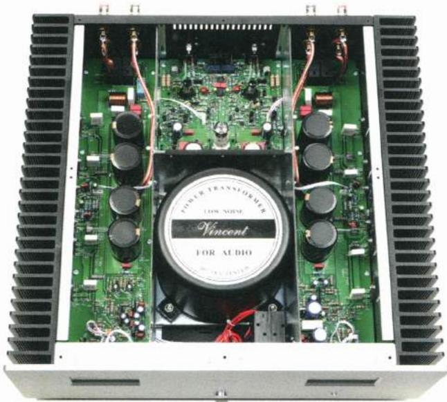
Hinten mittig die drei Röhren: Die Stabilisierung der Spannung übernimmt eine 6N15-Röhre. Zwei 6N16-Röhren im Differenz-Gegentakt bilden die Eingangsstufe.
