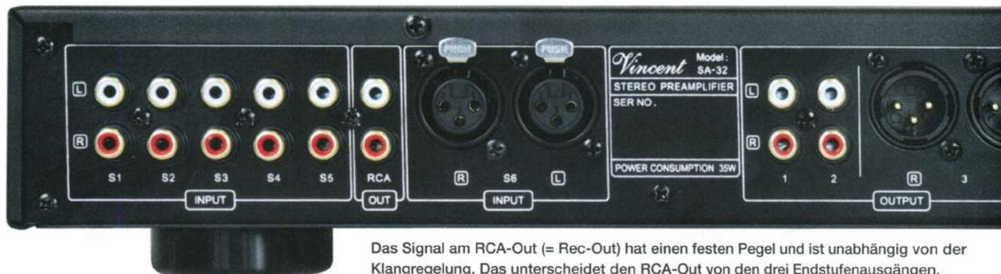
Das Signal am RCA-Out (= Rec-Out) hat einen festen Pegel und ist unabhängig von der Klangregelung. Das unterscheidet den RCA-Out von den drei Endstufenausgängen.
